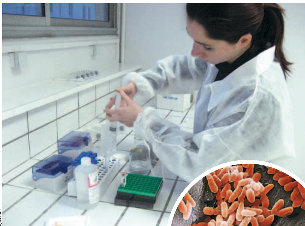
L'ATPmétrie mesure la quantité de micro-organismes dans l'eau (à droite, des pseudomonas aeruginosa ). Ce test utilise la réaction enzymatique entre l'adénosine triphosphate – la première source de vie de tous les organismes vivants – et la luciférase. La lecture du résultat s'effectue en quelques minutes, grâce à un luminomètre.
